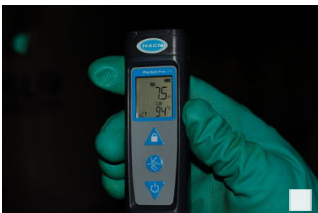
pH-Wert Messung sowie Temperaturmessung mit einem kostengünstigen Messgerät © LK NÖ/Harald Schally
